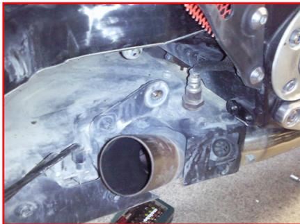
A l'aide d'une clé plate 17, dévisser la sonde Lambda en évitant de vriller les fils de connexion.
