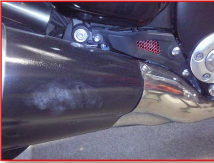
A l'aide d'une clé BTR de 5mm desserrer les 2 petites vis N°21 et démonter les enjoliveurs de silencieux.
