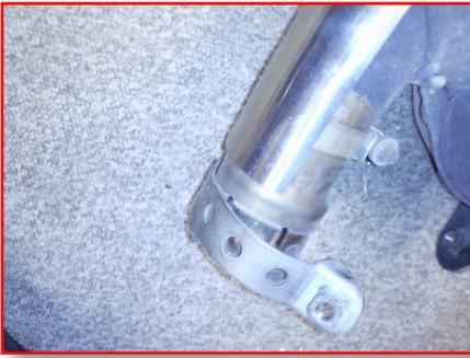
Sur les entrées de tube AV du catalyseur, retirer les colliers -
