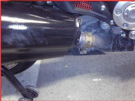
A l'aide d'une clé de 10 à pipe, dévisser la vis N°15 pour desserrer les colliers de serrage des tubes de sorties, sans retirer totalement la vis.
