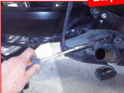
Munissez-vous d'un tournevis à douille équipé de 2 ou 3 allonges (35-40 cm au moins) et d'un embout BTR de 6mm.
