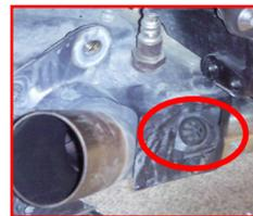
Retirer les embouts caoutchouc guidant les tiges d'enjoliveurs de silencieux
